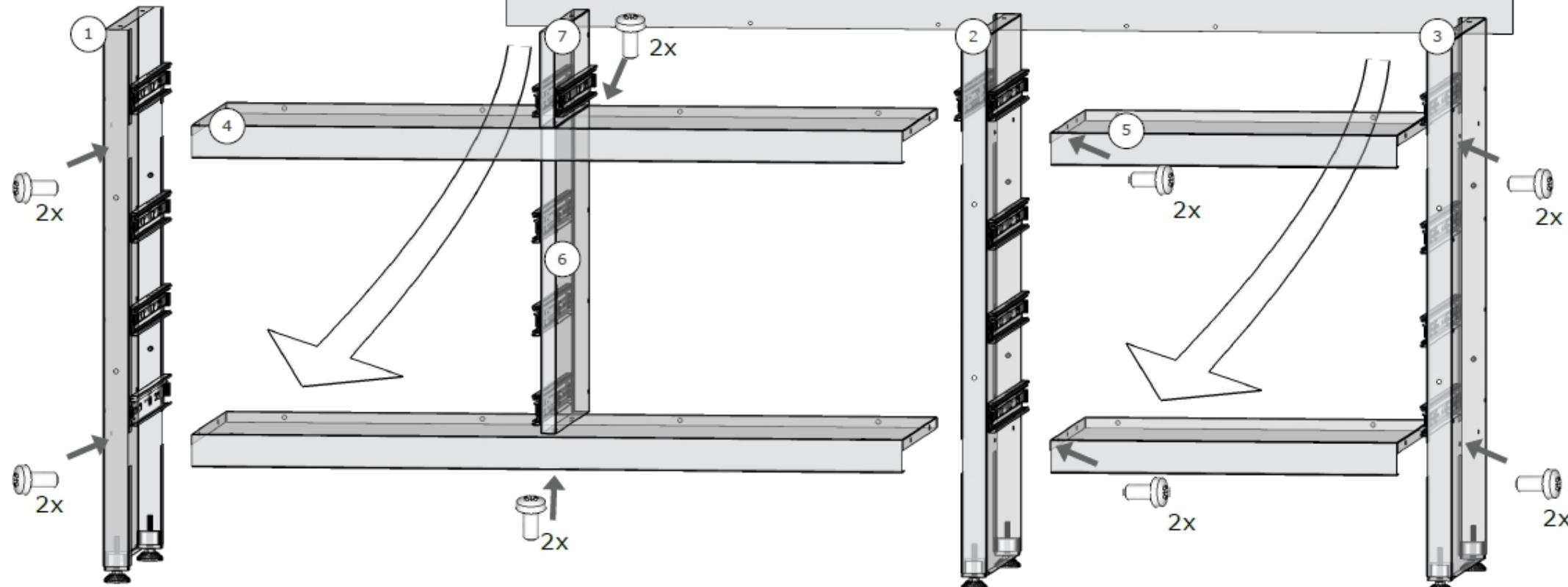
Nejprve spojte šrouby díly 1,2,3, s horizontálními díly 4(2x) a 5(2x), následně vložte a spojte díly 6,7. Na závěr ze zadu, namontujte díl 8.
