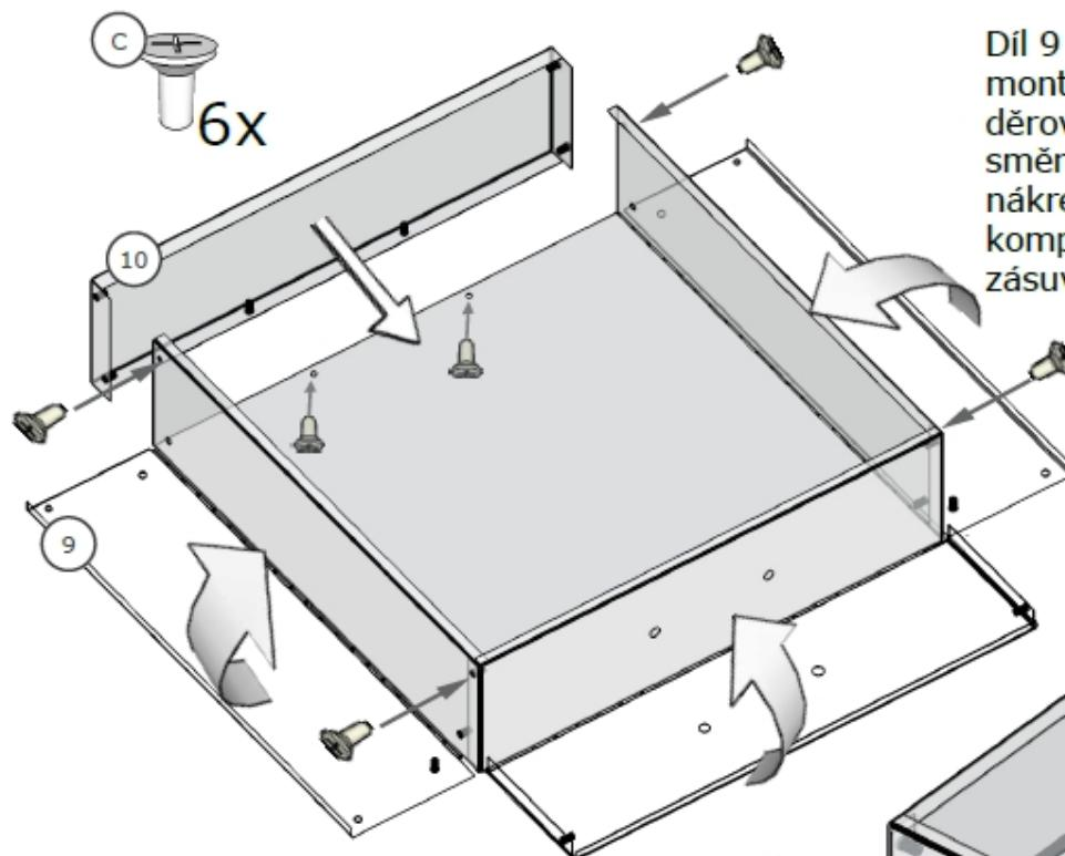
Díl 9 - zásuvka, je potřeba před další montáží ohnout. Díl ohněte rukou dle dřované linie předehnutými lemy směrem dovnitř. A sešroubujte dle nákresu. V dalším kroku dokončete kompletaci zásuvky. Takto složíte 9ks zásuvek.
