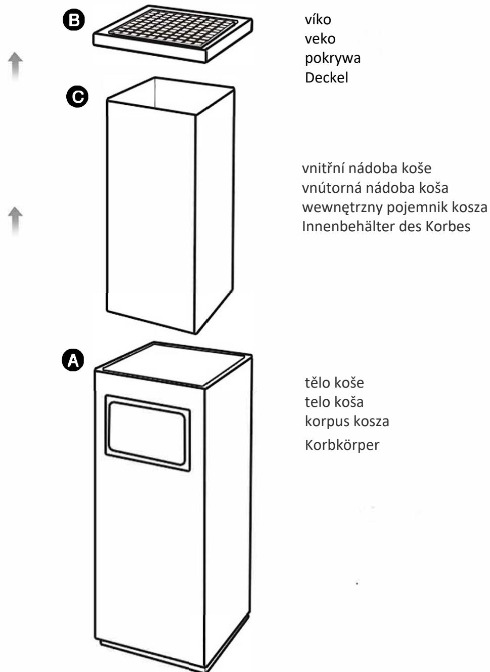
CZ: Sudejte víko (B) z těla koše (A), vyjměte vnitřní nádobu (C) a nasaděte na ni pytel na odpadky. Vložte zpět vnitřní nádobu (C) a víko (B) do těla koše (A).
