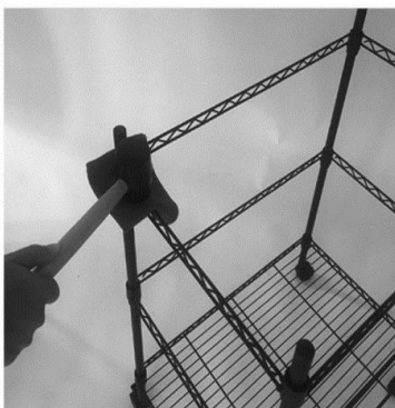
7. Pomocou gumovej paličky pritlačte každú policu, aby ste sa uistili, že bude štruktúra pevnejšia a stabilnejšia.
