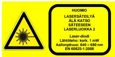
Jos käytetään muita kuin tässä ilmoitettuja käyttö- ja säätölaitteita tai suoritetaan muita toimintaojeita, se saattaa johtaa vaarallisiin säätyläivaltuksiin.
