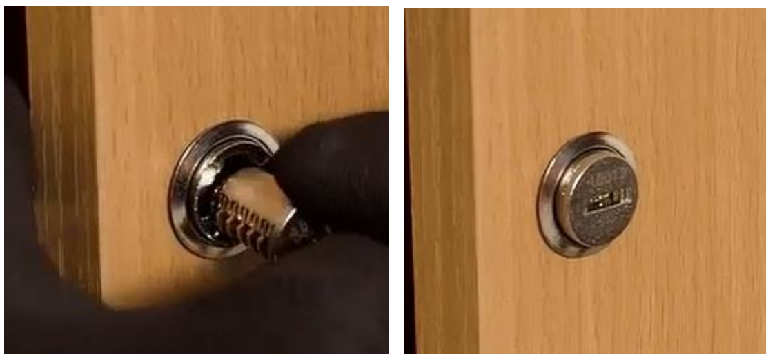
Obrázok 3 (vloženie a zacvaknutie poslednej časti zámku)
