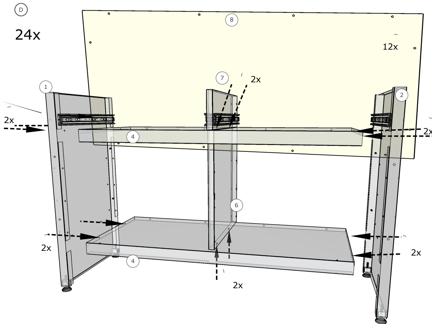
Nejprve spojte šrouby díly 1,2 s horizontálními díly 4(2x) následně vložte a spojte s díly 6,7. Na závěr, ze zadu, namontujte díl 8, šrouby (D)12x.
